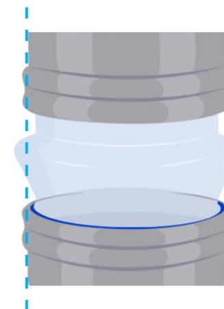
**NOTA:** È necessario prestare attenzione durante la saldatura per tenere conto del ritiro.
